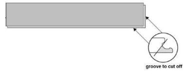
Groove to cut off Languette qui doit être coupée
